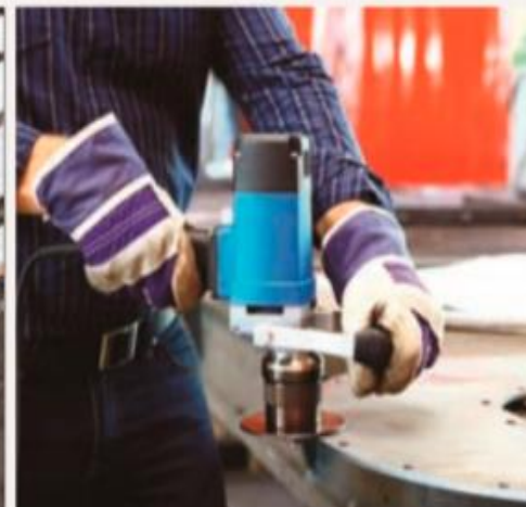
Serie EKF - Ideal para desbarbar, hacer cantos vivos y para el mecanizado de radios externos...
